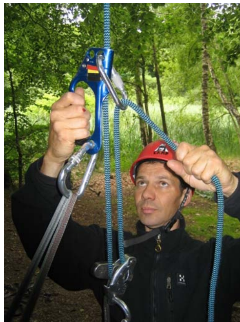
Figur 20: Vær nøje med at rebet ikke krydser. Der kan med fordel anvendes oval karabin øverst i Ascenderen.
