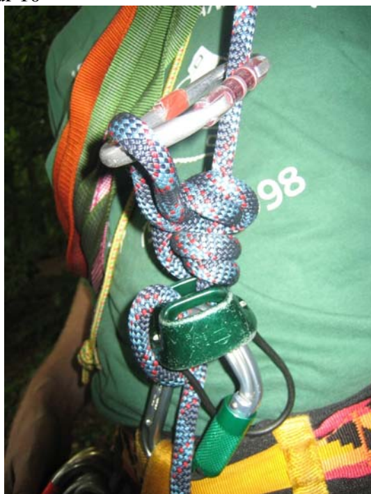
Figur 10: Afbinding af Sticht. Rebbugt Gennem karabinen, to halvstik og en karabin (almindelig eller låse).
