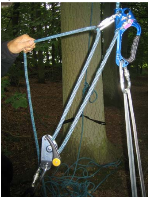
Figur 18: GriGri og Ascender kan monteres således.
