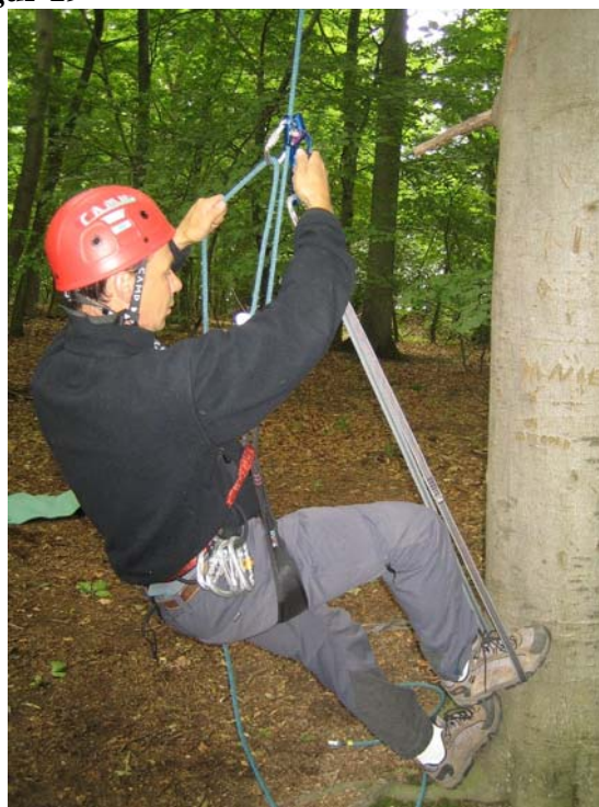
Figur 19: Foden sættes i slyngen der er forbundet til bunden af Ascenderen, den ene hånd i håndtaget og den anden hånd på rebet.
